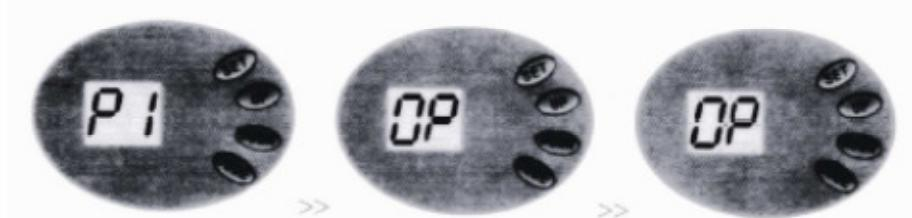
Stiskněte a držte SET, dokud se vám neukáže P1, znova stiskněte SET a ukáže se vám OP. Potom stiskněte UP. Vrata se zvedají. Když dosáhnete konečného otevření, stiskněte SET. Tím se poloha uloží.
